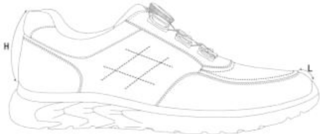
图3 成品尺寸测量部位示意图
