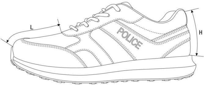
图3 成品尺寸测量部位示意图
